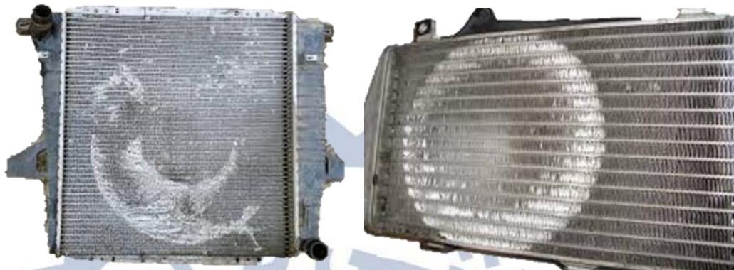
نمونه برخورد فن خنک‌کننده با شبکه رادیاتور
