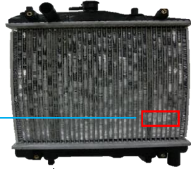
بادکردن شبکه رادیاتور به دلیل ایجاد فشار غیر متعارف سیستم خنک کننده بر شبکه رادیاتور
