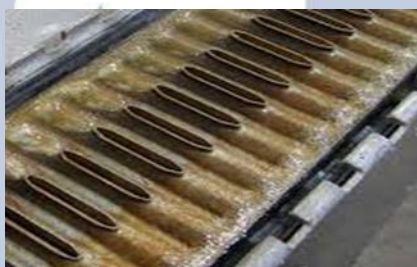
عدم تشکیل رسوب در اثر استفاده از محلول استاندارد رادیاتور
