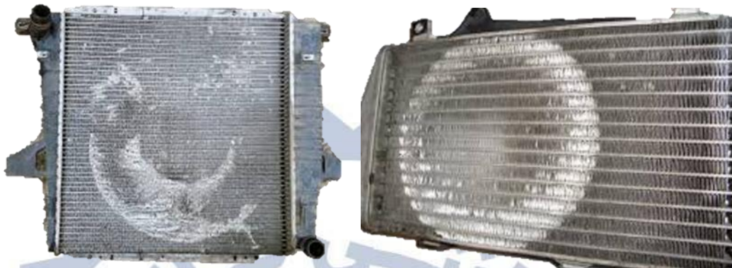
نمونه برخورد فن خنک کننده با شبکه رادیاتور
